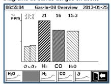
Diagrama de barras para hidrógeno  $(H_2)$ , monóxido de carbono (CO), humedad en aceite  $(H_2O)$  y temperaturas.
